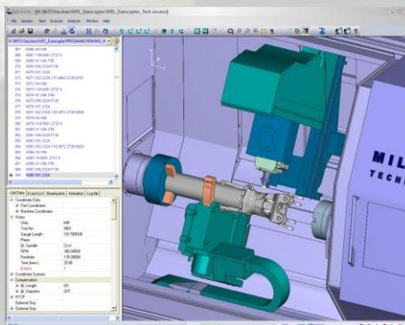
*IMSverify™ обеспечивает симуляцию станка с обнаружением столкновений для всех типов станков: фрезерных, токарных, фрезерно-токарных.*
